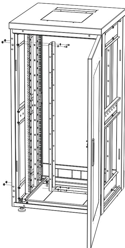
Рис. 2 Установка органайзера в напольный шкаф TFI
